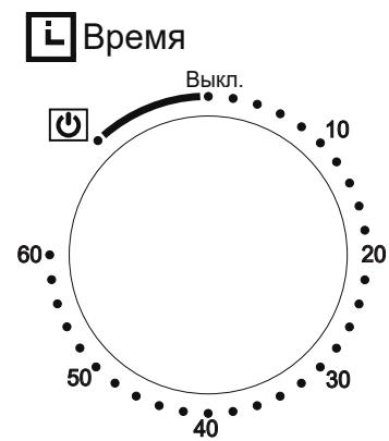
Поворачивая ручку по часовой стрелке установите нужное время приготовления. Вы также можете просто включить работу печи без использования таймера, для этого поверните ручку таймера в положение
