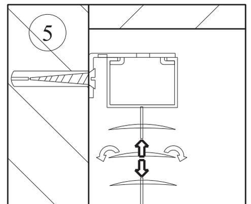
Поворот ламелей вокруг оси осуществляется ручкой управления по часовой или против часовой стрелки. Для того чтобы поднять жалюзи, просто потяните шнур управления вниз. Для того чтобы опустить жалюзи, отведите шнур управления к центру жалюзи, слегка потяните вниз, а затем медленно отпускайте.
